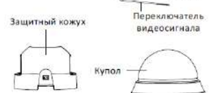
Рисунок 1-10 Купольная камера I типа
