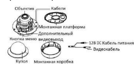
Рисунок 1-13 Купольная камера III типа
