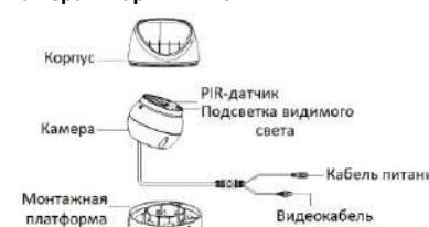
Рисунок 1-17 Камера «шар» III типа
