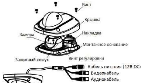
Рисунок 1-22 Компактная купольная камера
