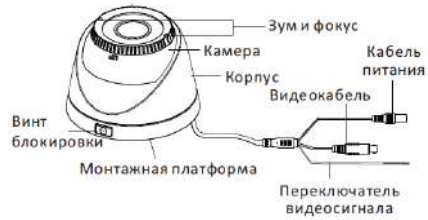
Рисунок 1-20 Камера «шар» V типа
