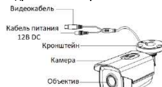
Рисунок 1-4 Цилиндрическая камера III типа
