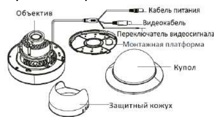
Рисунок 1-12 Купольная камера II типа
