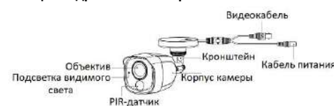
Рисунок 1-5 Цилиндрическая камера IV типа
